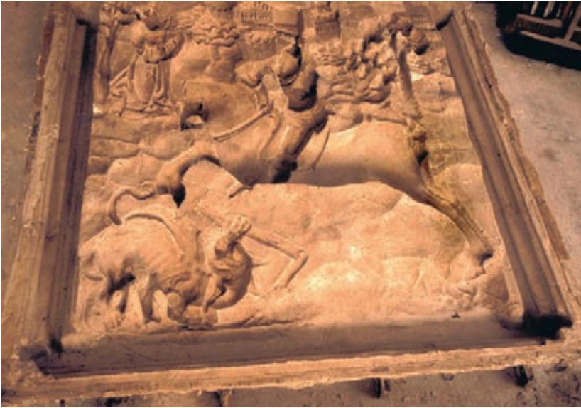
5 Ungewohnter Blick in die Negativform vor dem Einfüllen der Gussmasse.
