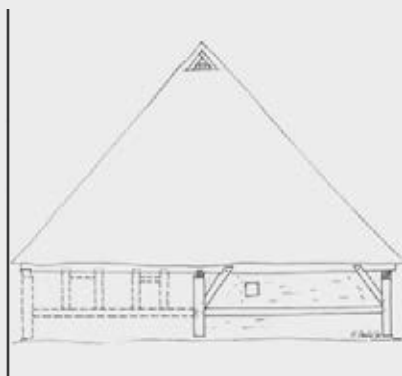
18 Schwedenhaus aus Almoshof, Sonntagsweg 1. Ostgiebel. Das Fachwerk lässt die Übergangszeit von der Verblattung hin zur Verzapfung erkennen. Die Kopfstreben sind oben mit dem Rähmholz (waagerechter Balken) noch verblattet, während sie mit den Ständern bereits verzapft sind. Zeichnung von Konrad Bedal.
